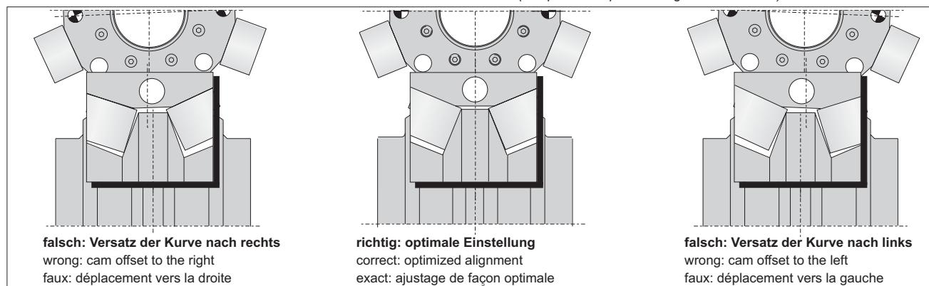
Bild 3: Richtige und falsche Anordnung des Einbausatzes
