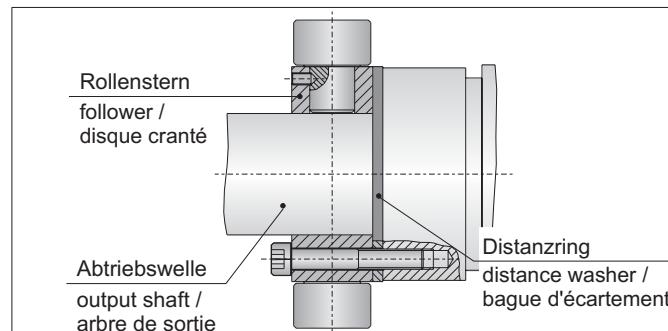
Bild 2: Rollenstern auf Abtriebswelle befestigt (Ausgleich mit Distanzring)
