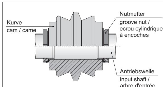
Bild 1: Globoidkurve mit Nutmuttern auf Antriebswelle befestigt
